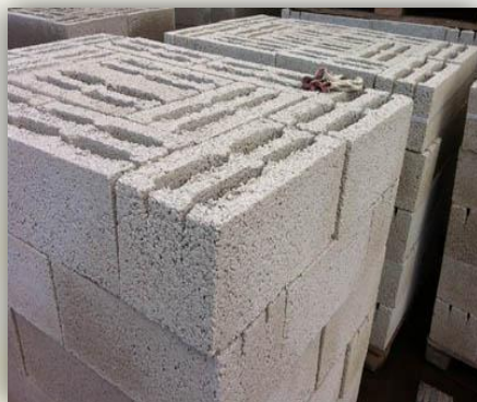
Керамзитобетонные блоки (изделия выполнены в соответствии с ГОСТ 8020-90)
