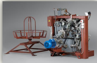
Пружинонавивочный автомат "Весна" (служит для выпуска двухконусных пружин с наличием узлов на опорных витках)
