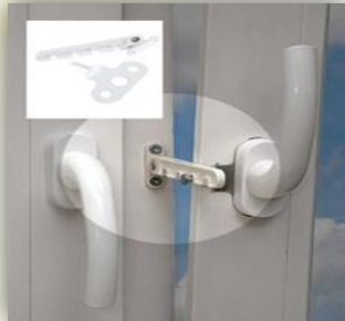
Ограничитель открывания (регулируют величину открывания поворотной створки с зазором между створкой и рамой приблизительно от 10 до 70 мм)
