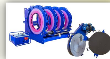
Сварочный аппарат Volzhanin 1200, диаметр 710-1200 мм
