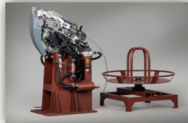
Сборочная машина "Кузнечик" (предназначена для крепления рамки каркаса к сшитому пружинному блоку)
