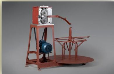
Сшивная машинка "Вьюн" (используется для соединения в блоки отдельных пружин посредством формируемой из проволоки спирали)
